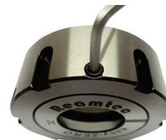
Assemblare la pinza (2) con la ghiera (1) e inserirli nel porta-utensili. Inserire il codolo dell'utensile nella pinza e serrare la ghiera (1) usando la chiave di serraggio (3) che è di una grandezza maggiore rispetto a quella normalmente utilizzata per quella dimensione di ghiera. Es. La ghiera EZ-Zero ER25 utilizza la chiave ER32.
