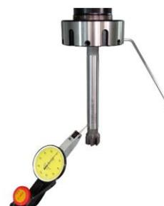
Quando il run-out è stato corretto, serrare tutte le viti rimanenti e controllare nuovamente che il run-out non sia stato modificato.
