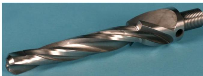
Queste punte si caratterizzano per la guida integrata e i tre taglienti che sono stati ideati per eseguire in un'unica operazione l'alesatura, la lamatura ed il raggio. Tutto questo per fori fino a 8 gradi e con utilizzo previa foratura. La guida posteriore non tagliente garantisce la perfetta concentricità dell'utensile, senza alcuna deformazione del foro.
