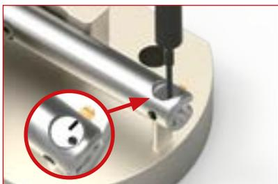
C'è una tacca e la spina di movimento nera è visibile (vedi nota pag. 53). Spingere la spina di movimento attraverso il porta utensile utilizzando il diametro minore della spina di assemblaggio (stessa direzione per assemblare e disassemblare).
