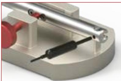
Utilizzare il diametro maggiore della spina di assemblaggio per premere la lama al di fuori del supporto lama.
