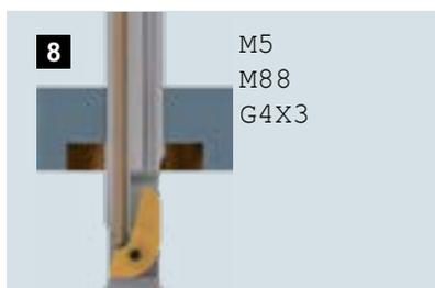
8 Fermare la rotazione, refrigerante ON, 2-5 sec di attesa (attenzione alla pressione del lubrificante), la lama si ritrae. Pressione refrigerante consigliata: 20-50 bar
