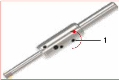
Continuare a ruotare la vite “tensione lame” in senso anti-orario finchè è possibile ritrarre le lame con una pressione manuale. **Sostituire le lame solo quando sono lasche (quando non sono in tensione).**
