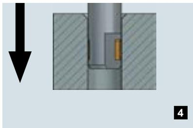
Quando le lame sono rientrate, il DEFA si muove attraverso il foro, sempre in rotazione. Il sistema di controllo riduce automaticamente al minimo la spinta radiale delle lame.
