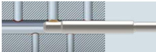
Figura 2: Numerosi fori intersecanti sbavati in un unico passaggio attraverso il foro principale.
