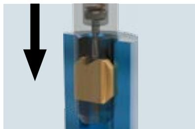
Nonostante la rotazione del mandrino, la lama passa attraverso il foro senza danneggiarlo. Anche fori alesati possono essere percorsi senza danni.
