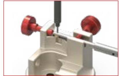
Estrarre con attenzione la spina di movimento dal foro. Tenere saldamente l'utensile di assemblaggio fino alla completa fuoriuscita della spina. Se necessario utilizzare un piccolo martello
