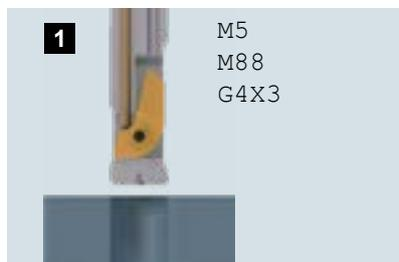
1 Posizionare l'utensile al di sopra della superficie superiore del pezzo, mandrino fermo, refrigerante ON, 2-5 sec di attesa (a seconda della pompa), la lama si ritrae (pressione consigliata 20-50 bar).
