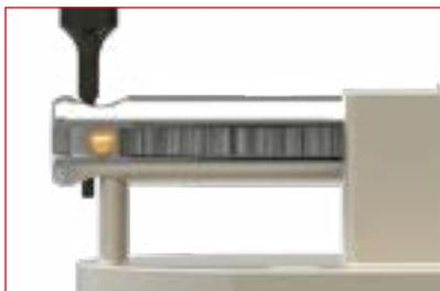
Inserire la spina di assemblaggio al fine di identificare il corretto posizionamento della lama e di pre-centrarla per inserire la nuova spina di movimento.
