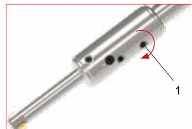
Continuare a ruotare la vite “tensione lame” (1) in senso orario finchè non si ottiene la resistenza desiderata. Il diametro dello smusso precedentemente regolato rimane il medesimo dopo la sostituzione delle lame. Per i valori di riferimento della resistenza delle lame, vedere a pag. 122.
