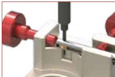
La spina di assemblaggio deve essere pari con entrambi i lati del corpo utensile.
