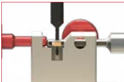
Utilizzare la spina di assemblaggio per inserire la spina di movimento a livello della lama. Smontare l'utensile.
