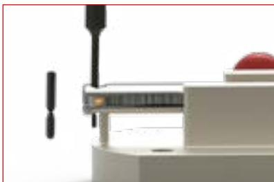
Inserire la nuova spina di movimento nel foro dalla parte corta finché la parte posteriore della stessa sia pari con il porta utensile.
