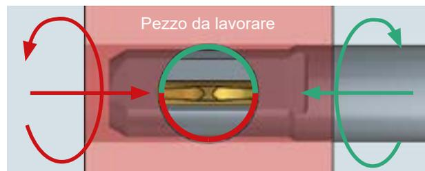
Figura 3: La lama è concepita per lavorare in spinta e in tirata. Prima di tornare indietro, è possibile invertire la rotazione per lavorare una seconda volta in tiro i fori, al fine di garantire la migliore stabilità di processo.
